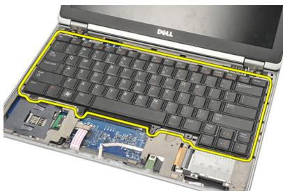
8. 断开键盘电缆与系统板的连接。
