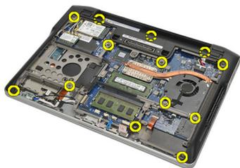
10. 从计算机背面开始，轻轻提起底部基座机箱，并小心地从计算机卸下真品证书 (COA) 标签，然后将整个底部机箱从计算机中提出。
