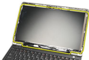
6. 剥下将低压差分信号 (LVDS) 连接固定到显示屏面板的胶带。
