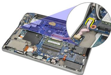
10. 拧下固定无线开关的螺钉。
