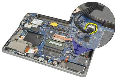
10. 拧松散热器上的固定螺钉，并拧下 CPU 风扇的螺钉。
