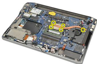
11. 卸下散热器和 CPU 风扇部件。
