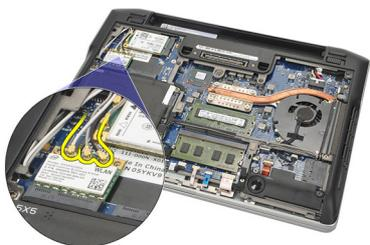
5. 拧下将 WLAN 卡固定到计算机的螺钉。
