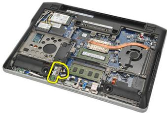
9. 断开电缆与 Bluetooth 模块的连接。
