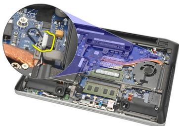
5. 拧下两个扬声器上的固定螺钉。
