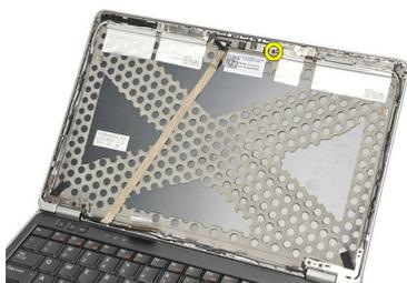
6. 通过断开显示屏顶部护盖上的电缆，卸下摄像头和/或麦克风。
