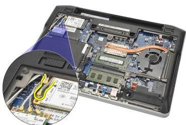
5. 拧下将 WWAN 卡固定到计算机的螺钉。
