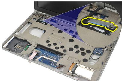
20. 断开 LVDS 电缆的连接。
