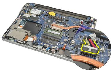
10. 将直流电源输入连接器从计算机中提起并卸下。
