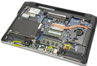
6. 翻转计算机。使用塑料划片，将掌垫的左上角轻轻地撬起。将塑料划片沿掌垫的上侧滑动以释放所有的卡舌，然后释放掌垫左侧、右侧和底部的卡舌垫。
