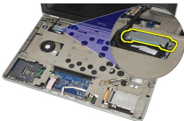
11. 断开 LVDS 电缆与系统板的连接。
